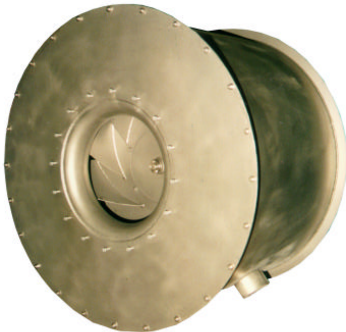
IGW -Zentrax-Ventilator für einen Flugzeugträger. Größe 400, 2.000 m 3 /h, 800 Pa, 1.1 kW.
