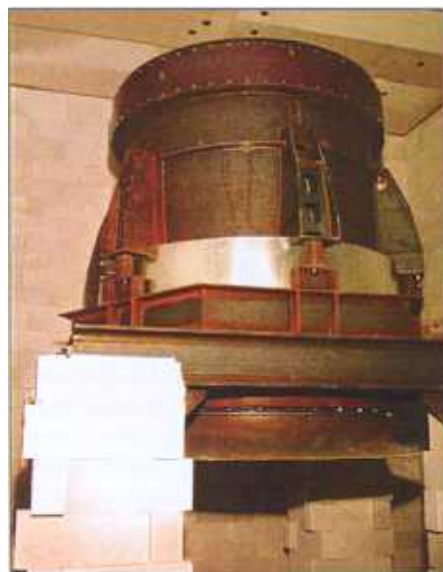
Axiallüfter D = 2000 mm / 250 kW vor dem Versuch.
